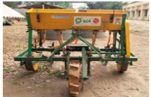
Mini tractor drawn seed drill
